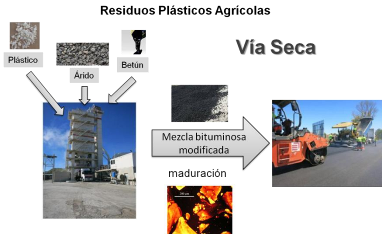
Fig. 4: Esquema de obtención de asfalto modificado por vía seca.
