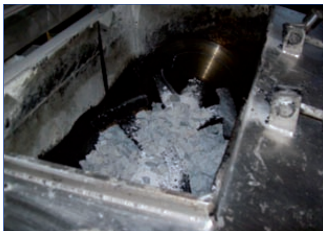
Foto 5. Incorporación del residuo plástico dentro del tanque mezclador en la fabricación en laboratorio de las mezclas betún-polímero.
