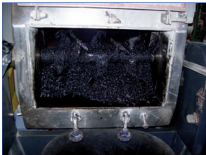
Foto 6. Muestra de mezcla betún-polímero obtenida en el tanque mezclador para el estudio en laboratorio.
