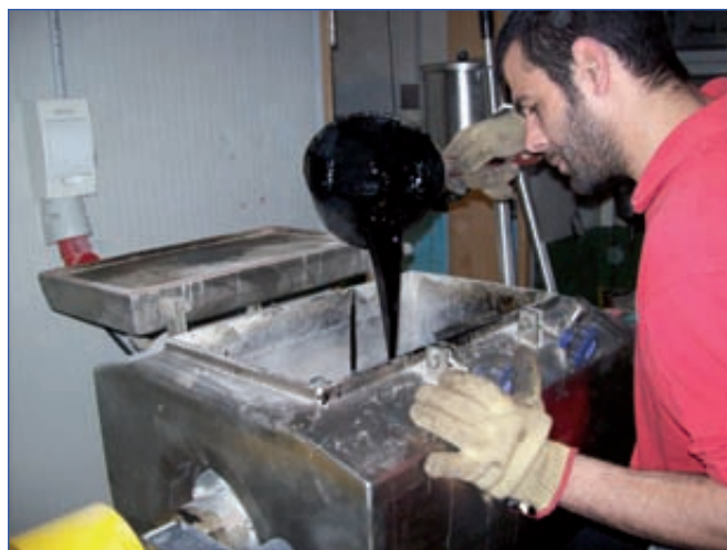
Foto 4. Incorporación del ligante en la fabricación en laboratorio de las mezclas betún-polímero.
