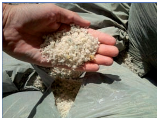
Foto 2. Los polímeros plásticos de origen agrícola seleccionados son polietilenos de baja densidad.
