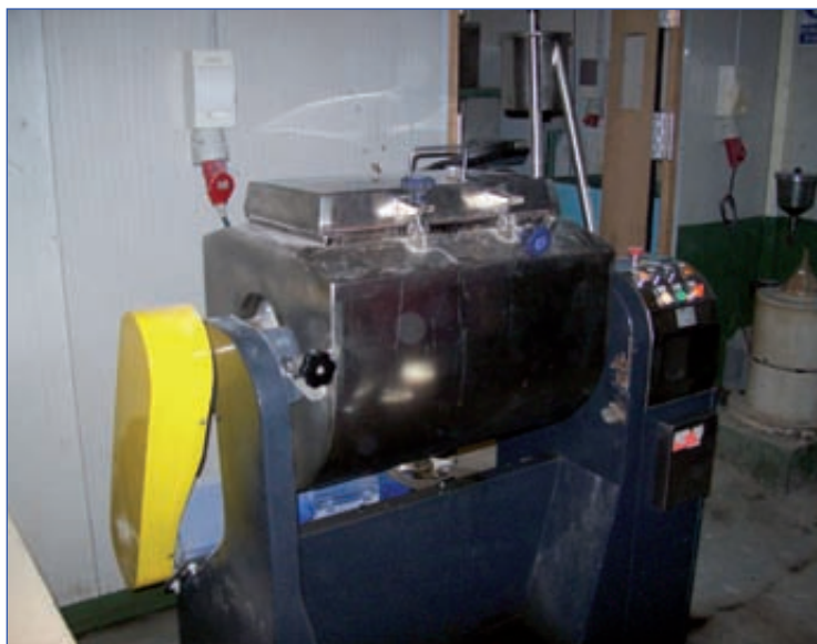
Foto 3. Amasadora de laboratorio para la fabricación de las mezclas.
